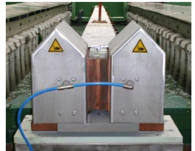
导电V-铜座电气连接的质量取决于接触区的材料、横截面、尺寸和涂饰，以及接触压力。这就决定了连接处导电V-铜座与飞巴电气接触电阻和最终的运行情况 and 寿命。因此，导电V-铜座出现更高的接触压力时，电气电阻及所产生的热力将降低。根据这个原理，我们开发了Titan系统。
