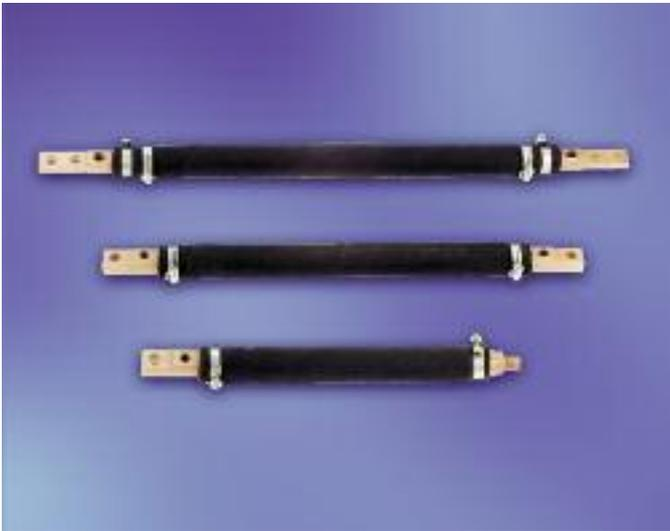
我们的水冷单芯电缆具有了 druseidt 标准接头 (B 型) 和符合 DIN EN ISO 8205-2 (C + D 型) 的接头。通过无焊压接方式与内部导线相连接, 从而保证最佳电流传导。内部导线绞合与适于高品质焊接机器人的冷却水管实现电缆高柔性。我们标准软管的壁厚为大约 4.5 mm (见目录第 51 页技术说明)。应用于特殊或特别容易有问题的应用, 应用于一些截面积可交付具有减小壁厚或截面积最高 1000 mm<sup>2</sup> 的软管。
