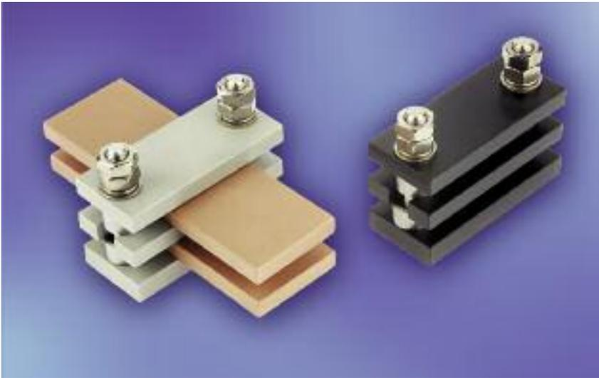
用于滑动支承一个或两个较长轨道的导电轨支架，它们由于热膨胀必须滑动停留在支架中。这种规格中上卡箍件不是在轨道上，而是在螺栓上。安装简单且节约时间，因为定位螺栓在安装前已被拧入绝缘支架，安装时可以简单放入导电轨。
