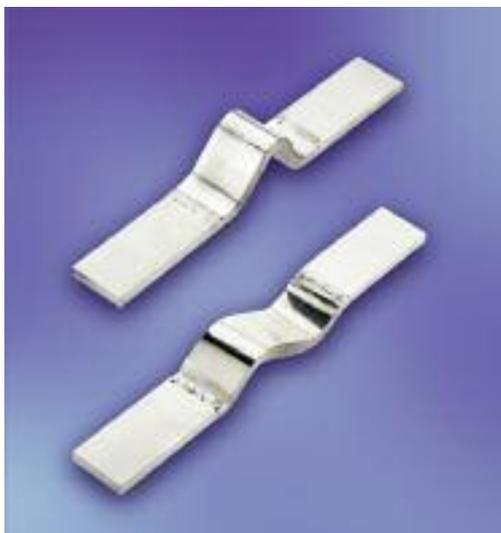
柔性铝伸缩带由厚度为 0.3mm 的纯铝金属箔制成。在末端焊接实心铝件。待焊接部件在保护气体下借助电产生的电弧被局部熔化。在应用中使用的保护气体防止金属熔融物氧化。连接面宽度尺寸被定义成可以将多条带安装成相邻之间的间距约 2mm（诸如用作发电机领域内接头）。如有需要还可以提供具有孔的，诸如根据 DIN 43673 第 1+2 页、DIN 42606 第 2 页或者符合数据/图纸。
