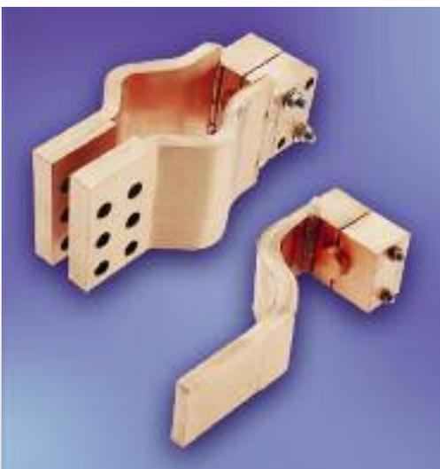
为了连接具有绝缘套管或圆形销作为输出端的变压器，我们生产具有扩张性以及用于圆形接头的焊接夹紧固装置的柔性铜接头。对于每个接头几千安培的功率的情况提供，诸如用于钢铁厂变压器，尺寸定制化为变压器设计。它们可以一侧具有端子，另一侧具有扁平接头用于传输到轨道系统或接触板，或者两侧为连接到管系统具有夹紧固装置。根据功能和要求的截面积，端子的上下部分具有一个伸缩带，还可以上部分具有伸缩带，下部分设计成卡箍件。
