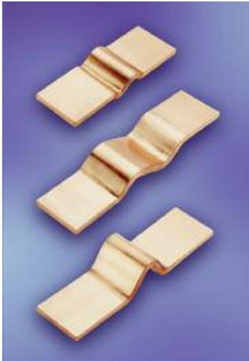
制作下列伸缩带使用符合 DIN EN 13599 的铜 HCP 金属箔（以前是 SE 铜），厚度是 0.1 或 0.3 mm。连接末端是压焊规格。压焊是一种特殊电阻焊接工艺，它可以整个面紧凑且在不使用焊接添加料的情况下可靠焊接。
