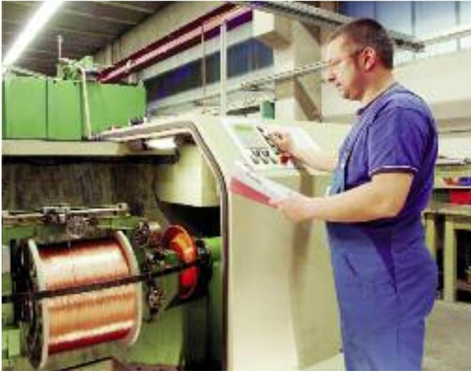
Trenzado e hilado de conductores altamente flexibles
