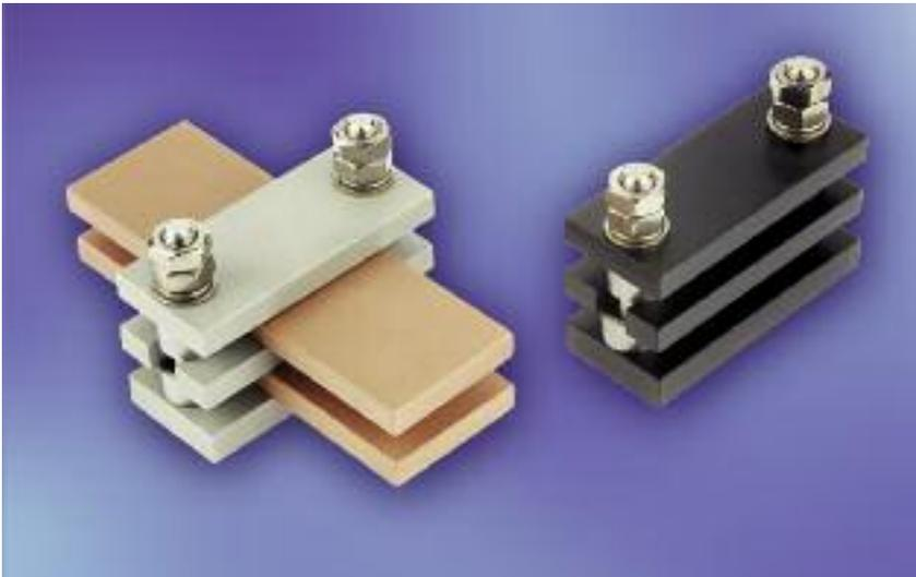
Portacarriles como sujeción **deslizante** de uno o dos carriles largos, que deben poder deslizarse sobre el soporte debido a la dilatación por calor. En esta versión, la pieza de sujeción superior no reposa sobre los carriles sino sobre el perno. Forma de montaje sencilla y rápida, porque los pernos verticales ya están atornillados al soporte antes del montaje, permitiendo la sencilla colocación de los carriles de corriente durante el montaje.
