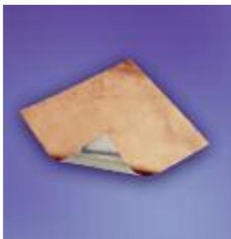
Los Placas bimetálicas Cupal constan de paneles de aluminio chapados en cobre. El punto de unión de ambos metales está situado en el interior del panel, impidiendo la entrada de aire y humedad. Con este material se puede realizar una unión de cobre y aluminio segura al contacto y protegida contra la corrosión. Además de los cuadros Cupal también suministramos arandelas y secciones con y sin taladros adecuadas a sus aplicaciones.
