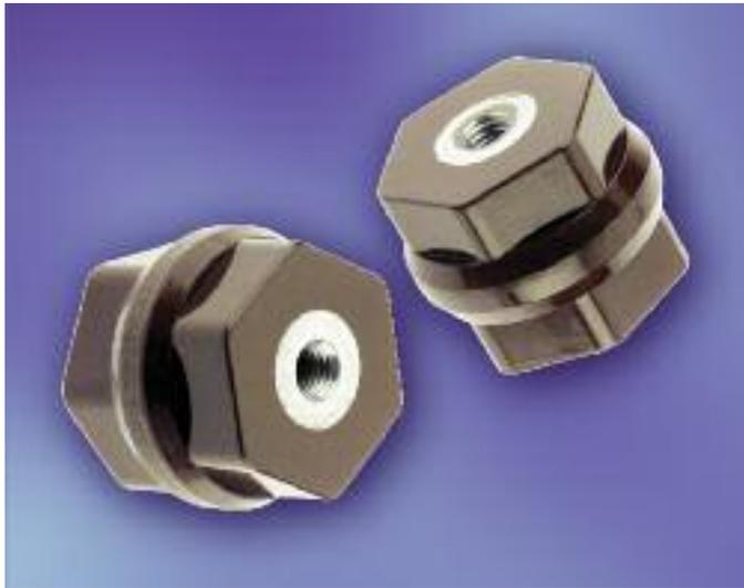
Nuestros soportes aislantes se fabrican con una resina de poliéster reforzada con fibra de vidrio. Se distinguen por su ejecución en hexágono doble, muy fácil de montar. Así tanto la parte superior como en la inferior de los tubos aislantes tienen una superficie hexagonal. Ambas superficies están desplazadas entre sí. Por tanto, los tubos aislantes se pueden montar y desmontar de forma rápida y segura incluso en espacios muy pequeños. Con ello se minimizan los costes de montaje.
