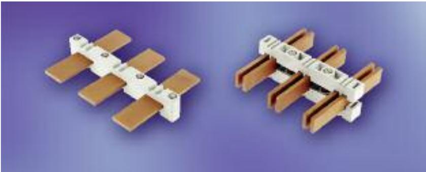
Portacarriles colectores de 3 polos de poliéster reforzado con fibra de vidrio, similares a DIN 16911 tipo 801. Adecuados para la sujeción vertical de carriles colectores de 5 y 10 mm de grosor (n.º de pedido 15636 + 15637) o bien, por fase, 2 unidades de carriles de 10 mm de grosor en vertical o 1 carril de 60 mm de anchura en horizontal (n.º de pedido 15638). La altura de los carriles puede variar con secciones adecuadas de manguitos de cartón duro.
